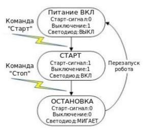
Важно: если светодиод на модуле горит до того, как судья послал команду «старт», это значит, что модуль находится в «стартовавшем» состоянии. В этом случае должна быть послана команда остановки, а робот перезапущен, чтобы модуль вернулся в состояние «Питание ВКЛ».
